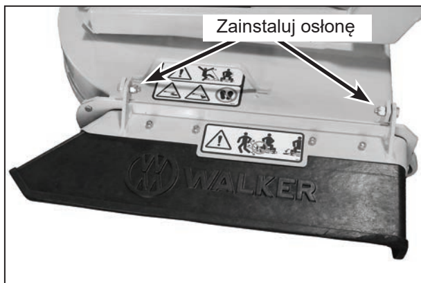
Montaż osłony na bocznym wyrzucie trawy z kosiska
