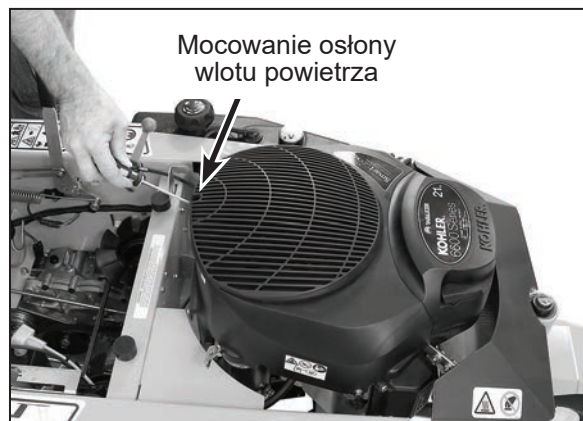
Demontaż stacjonarnej osłony wlotu powietrza
