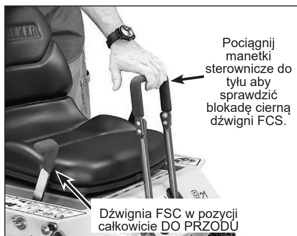
Test blokady ciernej dźwigni FSC
