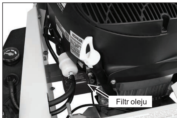
Lokalizacja filtra oleju (Pod filtrem paliwa)
