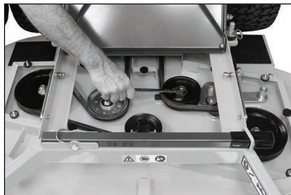
Napinanie paska ramieniem pośredniczącym platformy
