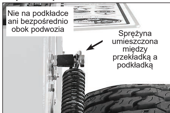
Sprężyna przeciwwagi zainstalowana na słupku ciągnika
