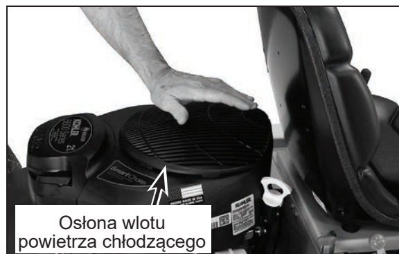
Sprawdzenie przepływu powietrza chłodzącego
