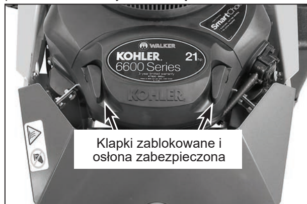
Zainstalowana filtracja powietrza
