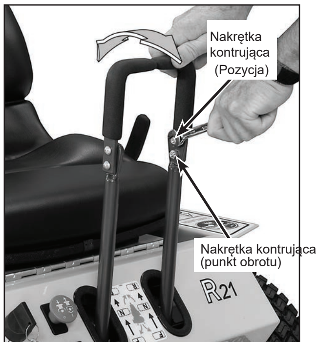
Regulacja manetek sterujących
