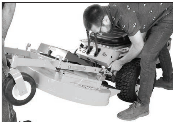
Zainstaluj sprężynę przeciwwagi na ramie nośnej
