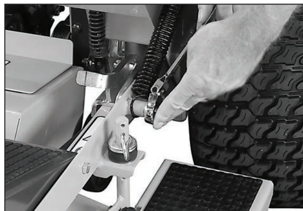
Zainstaluj nakrętkę na śrubie wózka
