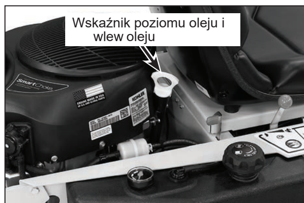
Miarka poziomu oleju i lokalizacja wlewu oleju
