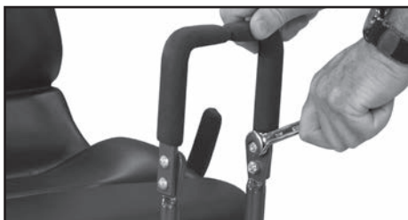
Zainstalowane uchwyty manetek sterujących
