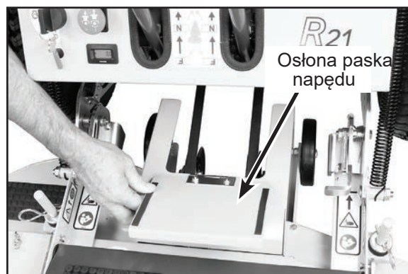
Podnieś osłonę paska napędowego, aby poprowadzić pasek
