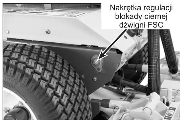
Nakrętka regulacji blokady ciernej dźwigni FSC
