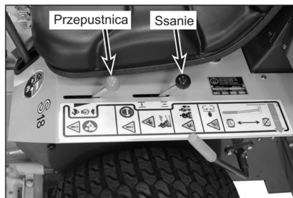
Lokalizacja dźwigni ssania i przepustnicy
