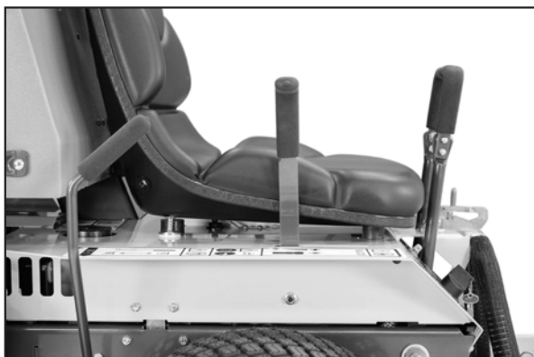
Prawidłowa pozycja LUZ-PARKOWANIE dźwigni FSC
