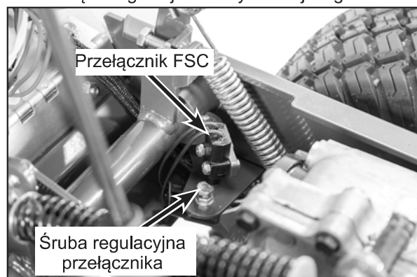
Położenie neutralnego przełącznika FSC
