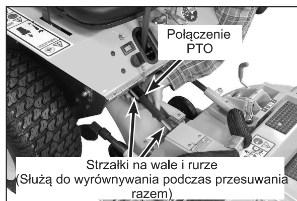
Połączenie wału PTO
