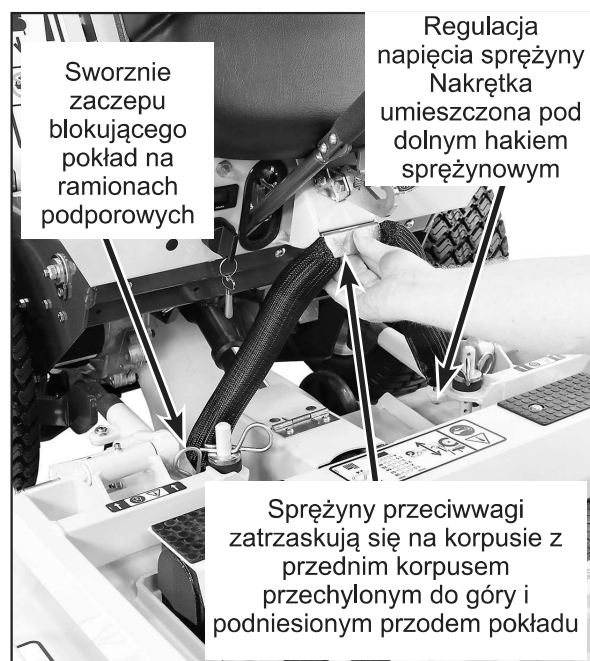
Montaż sprężyny przeciwwagi na platformie
