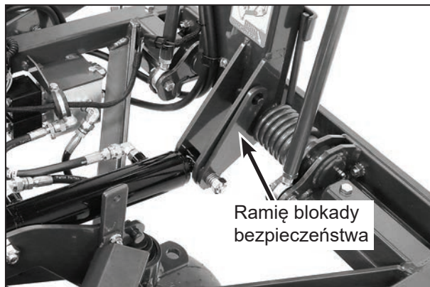
Ramię blokady bezpieczeństwa w pozycji rozłączone
