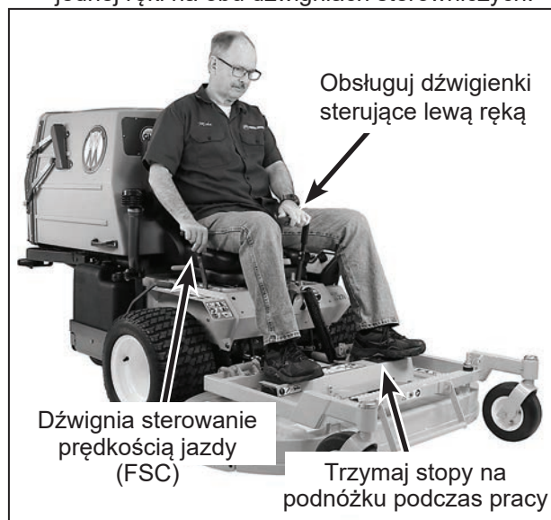
Prawidłowa pozycja dłoni operatora na elementach sterujących
