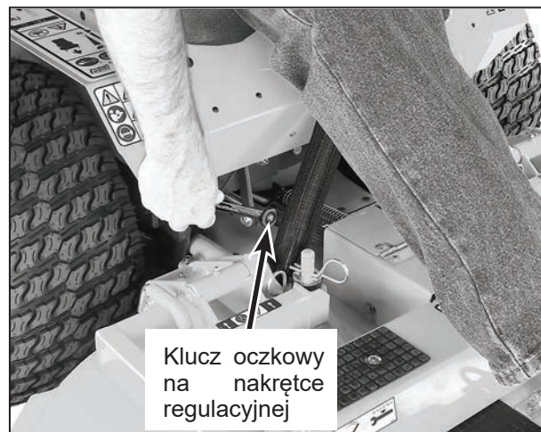
Regulacja jazdy na wprost
