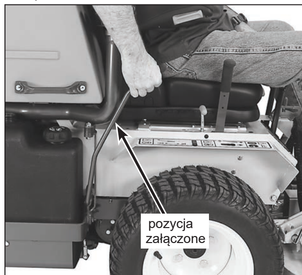
Sprzęgło noży załączone
