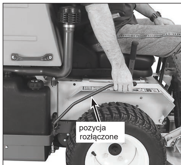
Sprzęgło noży rozłączone
