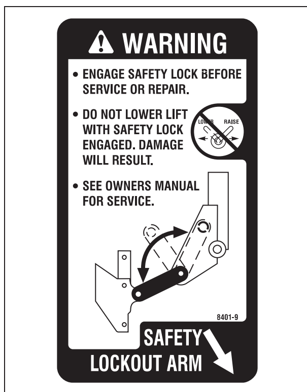
Naklejka, ramię blokady bezpieczeństwa (lokalizacja: dolne ramię podnośnika)
